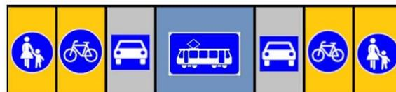
**Nachher**: Radfahrspuren in beide Richtungen, dem Radverkehr und dem Autoverkehr stehen je eine Spur zur Verfügung.
