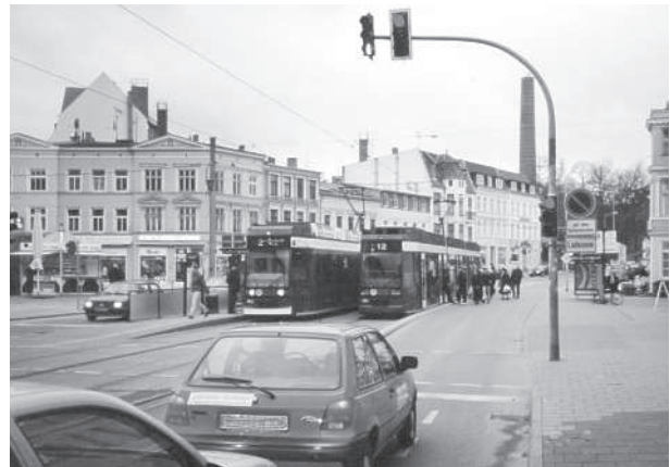
Abbildung 5 An Zeitinseln ist die einfahrende Bahn immer sicher erreichbar. Autos werden vor dem Haltestellenbereich per Ampel gestoppt.
