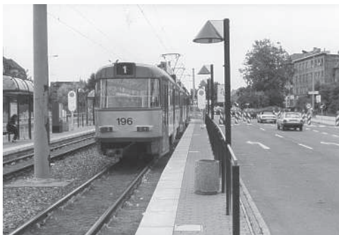
Abbildung 4 Haltestelleninseln müssen behindertengerecht und mindestens 2,50 m breit sein.
