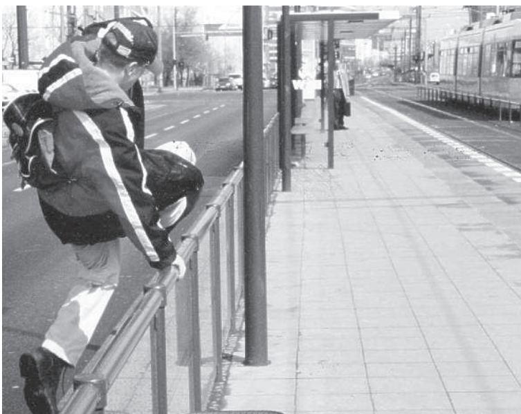
Abbildung 1 Bei fehlenden Haltestellenzugängen wird die Fahrbahn auch an ungesicherten Stellen überquert. Durch Absperrgitter oder Spritzschutzwände lassen sich Fahrgäste kaum aufhalten.
